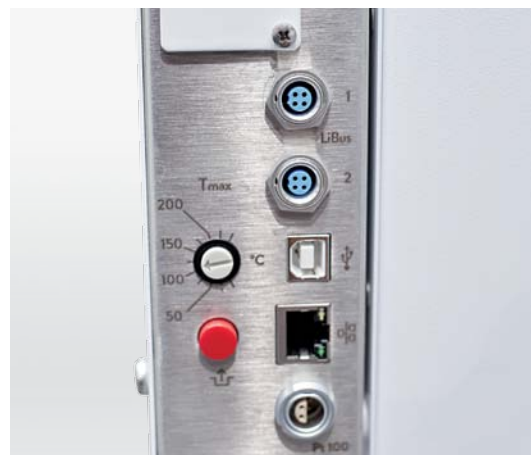
Ethernet- und USB-Schnittstelle sowie Pt100-Anschluss serienmäßig
