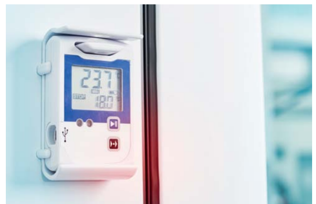
Der Datenlogger lässt sich magnetisch an den Variofreeze Tiefkühlgeräten fixieren und über einen USB-Anschluss konfigurieren sowie auslesen
