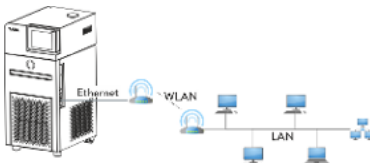
Abb. 14: Verbunden über LAN und WLAN
