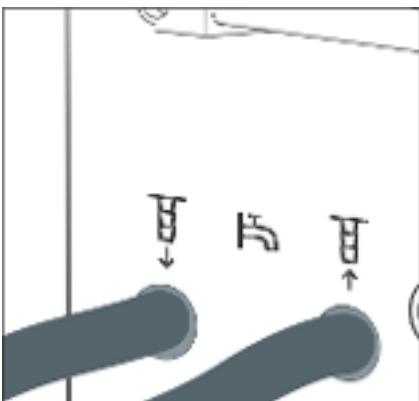
Abb. 21: Kühlwasser Eingang und Ausgang
