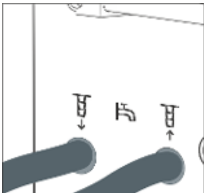
Fig. 21: Entrada y salida de agua de refrigeración
