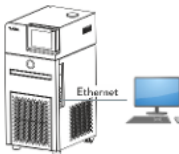
Fig. 12: Conexión a través de cable Ethernet
