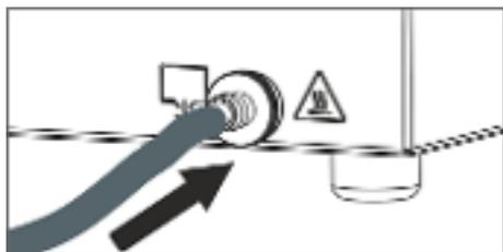
Fig. 23: Conexión de la manguera
