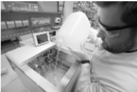
Fig. 22: Llenado del termostato de baño
