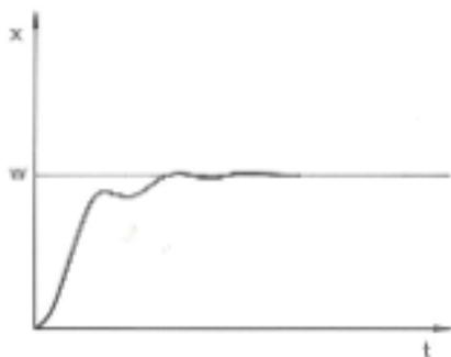
Fig. 60: Parámetro de regulación  $X_p$  demasiado bajo
