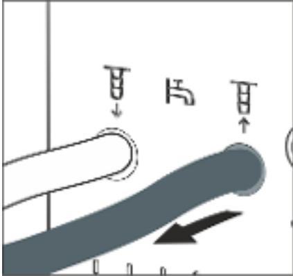
Fig. 73: Conexión de agua de refrigeración
