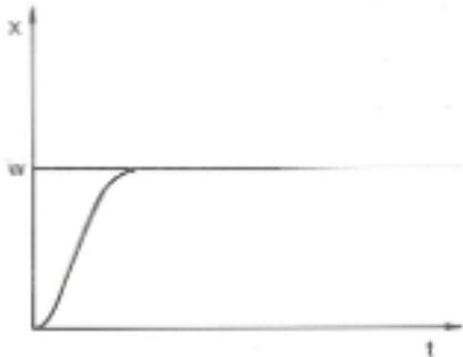
Fig. 58: Ajuste óptimo
