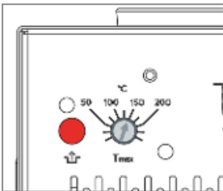
Fig. 7: Tecla de desbloqueo y temperatura máxima
