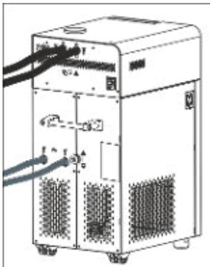
Fig. 20: Mangueras conectadas
