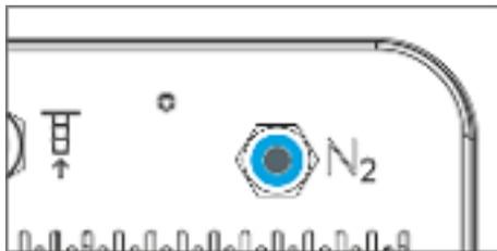
Fig. 8: Conexión para nitrógeno (N<sub>2</sub>)
