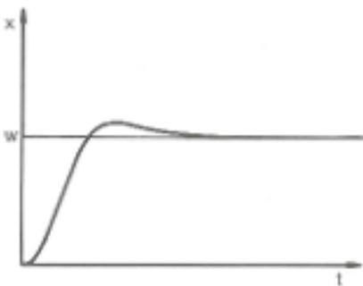
Fig. 59: Parámetro de regulación  $X_p$  demasiado alto
