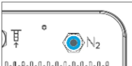
Fig. 5: Conexión de nitrógeno RP 290 E
