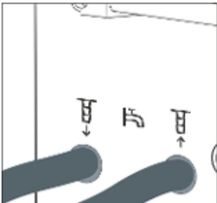
Fig. 21: Entrada y salida de agua de refrigeración
