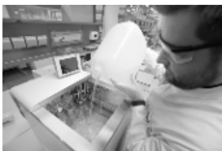
Fig. 24 : Remplissage du bain thermostaté
