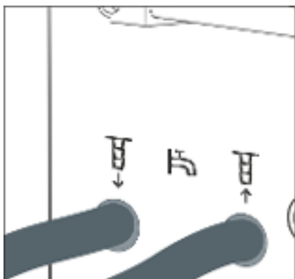
Fig. 23 : Entrée et sortie de l'eau de refroidissement
