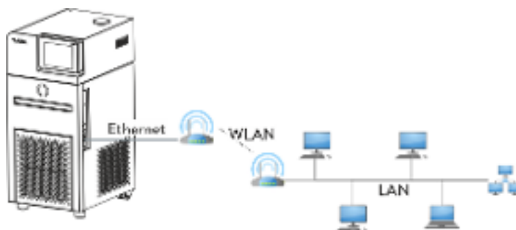
Fig. 16 : Connexion par réseau local et WiFi
