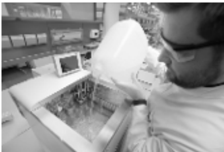
Fig. 24 : Remplissage du bain thermostaté
