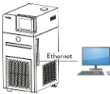
Fig. 12: Conexión a través de cable Ethernet
