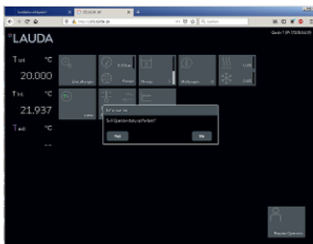
Fig. 73 : Serveur Web dans la fenêtre du navigateur
